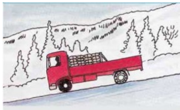
Рис. 2. Когда груз уложен в передней части, может понадобиться надеть цепи на задние колеса
