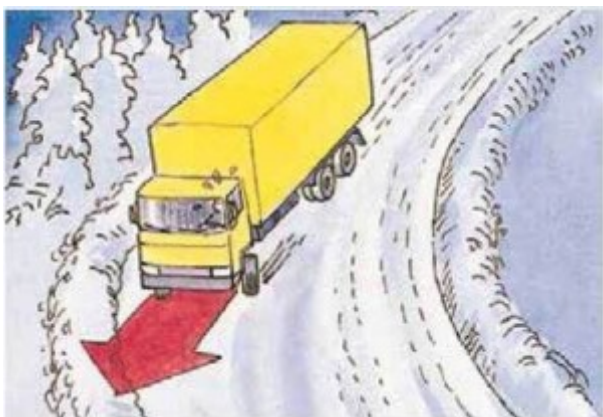
Рис. 3. На скользкой дороге может быть сложно справиться с управлением груженого тягача с двухосным мостом
